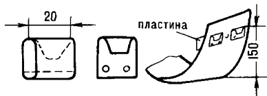
Рис.101. Изготовление и установка крючков
