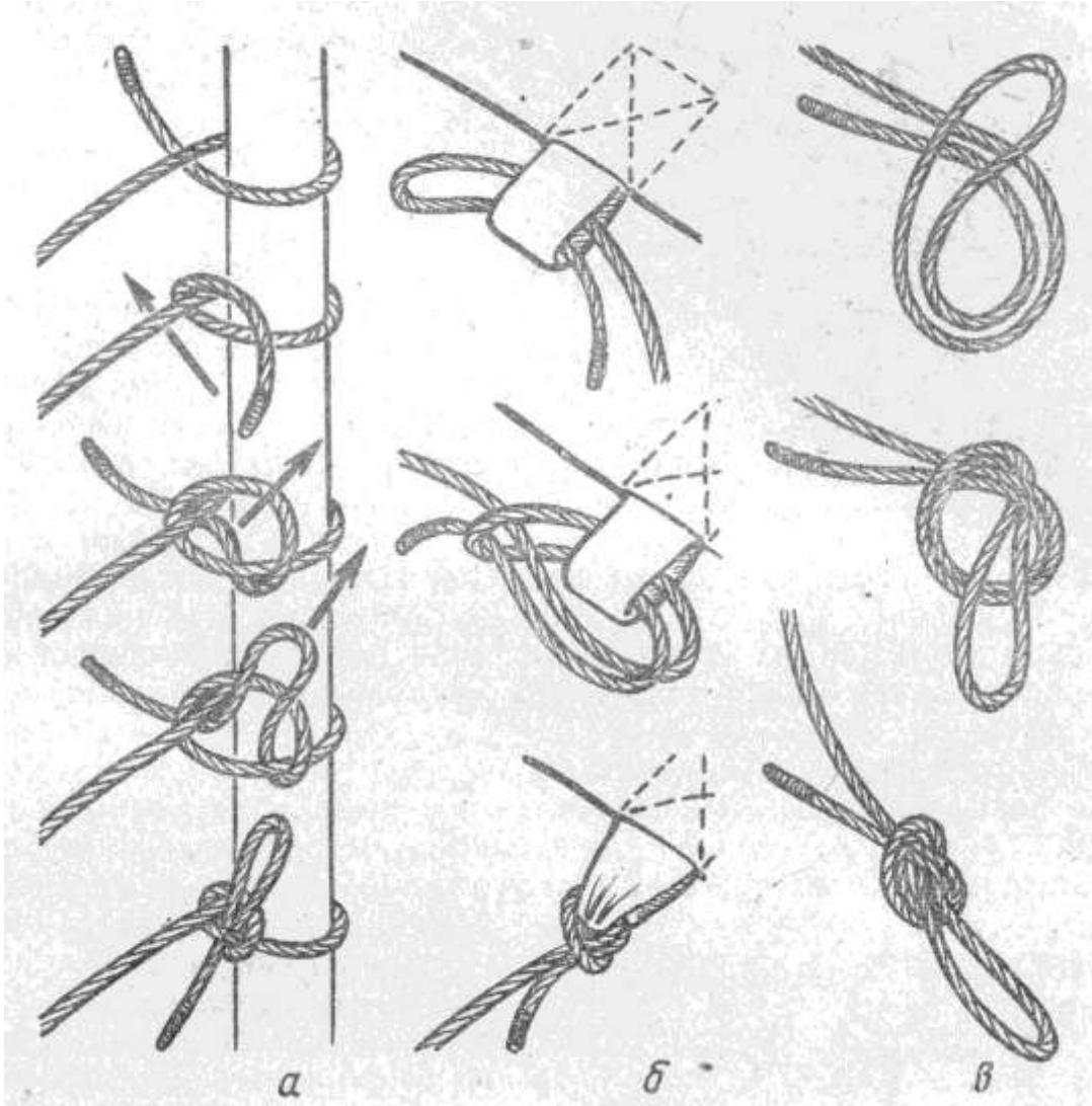
Рис. 17. Узлы, применяемые при установке палатки,
