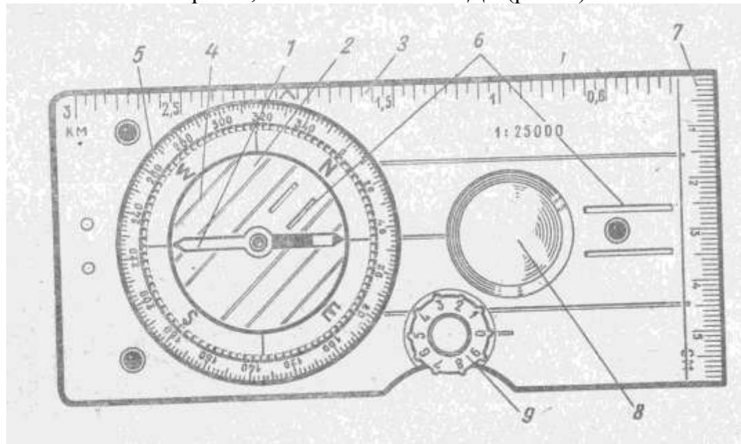
Рис. 7. Жидкостный компас «Спорт-3»: 1 — магнитная стрелка; 2 — резервуар с жидкостью («колба»); 3—масштабная шкала; 4—направляющие линии; 5—лимб, подписанный в градусах; 6—риски для определения направления движения; 7 — миллиметровая шкала; 8 — увеличительное стекло; 9 — шайба-шагомер.
