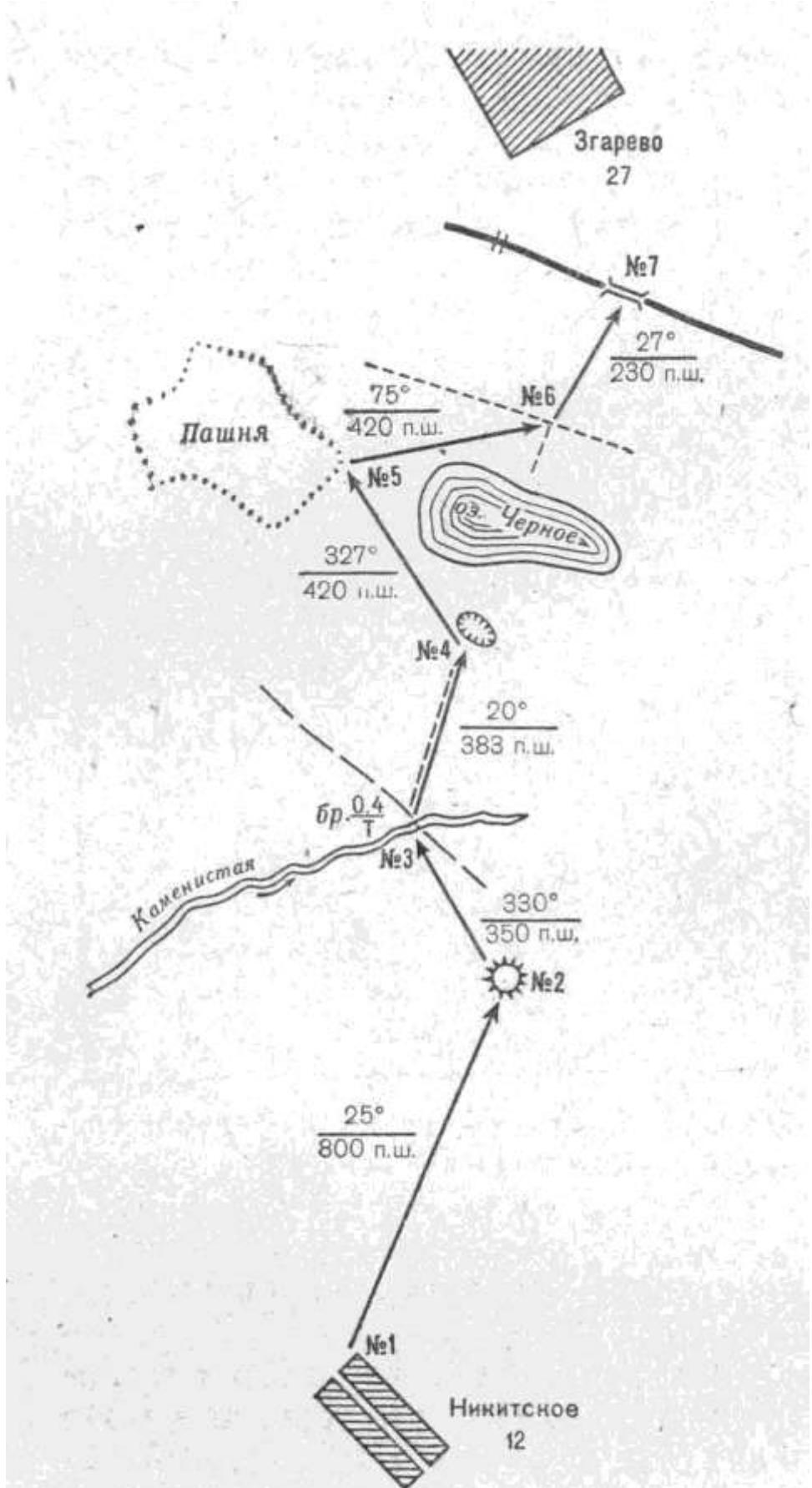
Рис. 14. Схема для движения по азимутам.
