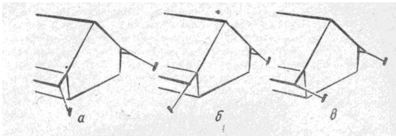
Рис. 18. Направление угловых оттяжек палатки:
