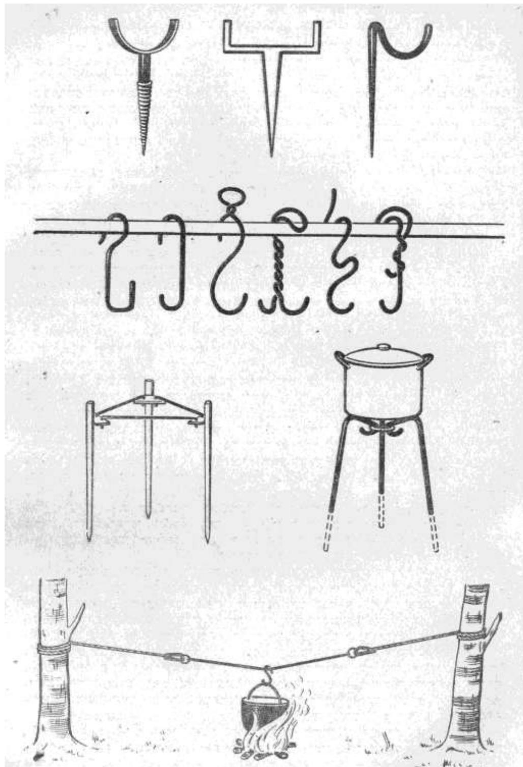
Рис. 28. Самодельные приспособления для приготовления пищи на костре.
