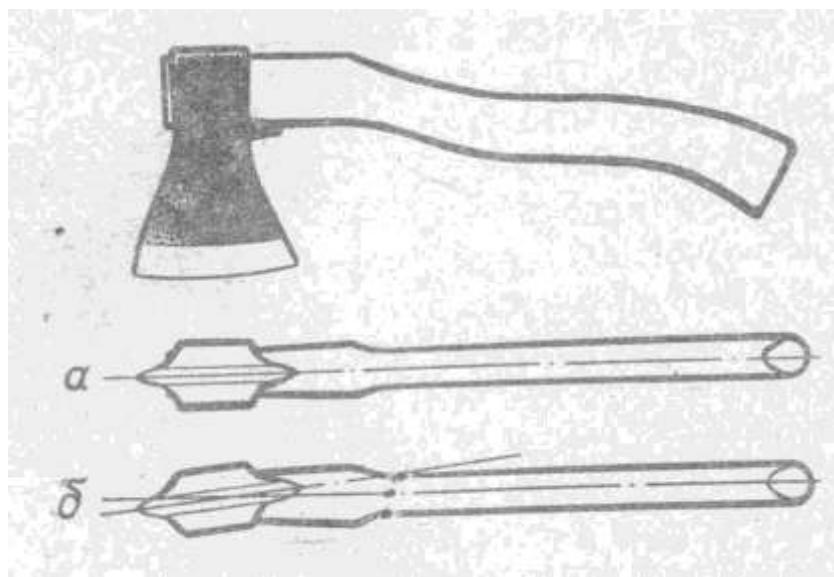
Рис. 5. Насадка топора: *a* — правильно; оба конца лезвия и пятка *б* — неправильно,
