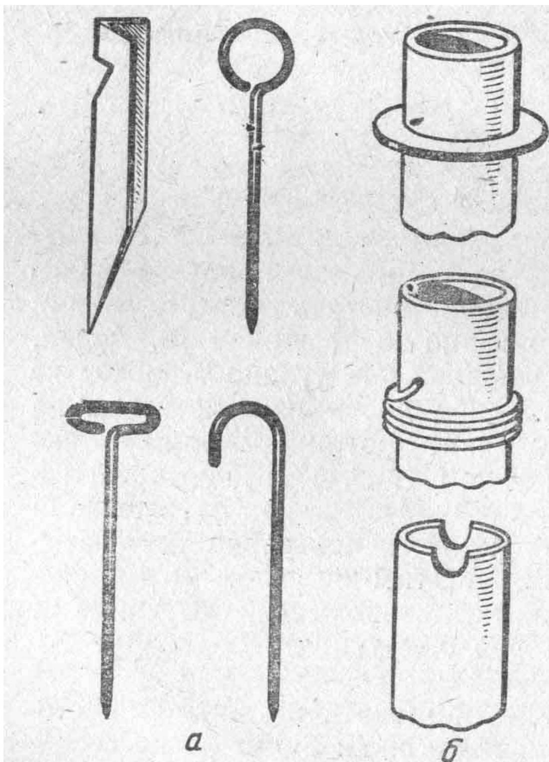
Рис. 19. Металлические штыри и опорные стойки для палатки.
